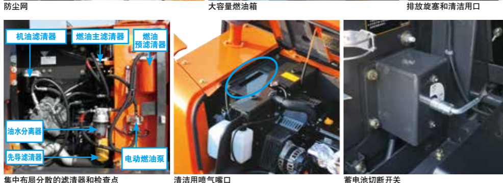
集中布局分散的滤清器和检查点 清洁用喷气嘴口 蓄电池切断开关
